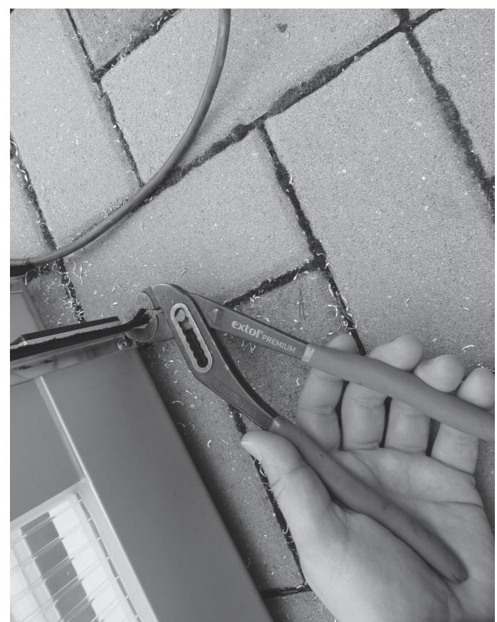
RAIL COVERS with the strip / KRYTKY KOLEJE s lištou / EMBOUTS DES RAILS avec baguette / BEDEKKINGEN VOOR DE RAILS met lijst / TAPPI PER BINARI con listello / ABDECKKAPPEN der Schienen mit Leiste / КРЫШКИ НАПРАВЛЯЮЩЕЙ С ПЛАНКОЙ / SKENSKYDD med en list / ZAŚLEPKI PROWADNIC z listwą
